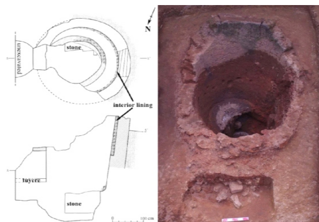
炉堆子炼炉线图及照片
